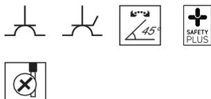
**Steckdose SCHUKO mit Klappdeckel in 45°-Stufen variable Einbaulage, erhöhtem Berührungsschutz, mit Schraub-Liftklemmen, Berker S.1/B.3/B.7**
