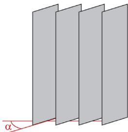
Lamelle verticali completamente chiuse (Posizione lamelle 100%)
