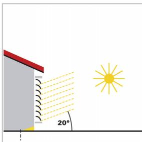
**Protezione solare quando il sole è in posizione intermedia**
