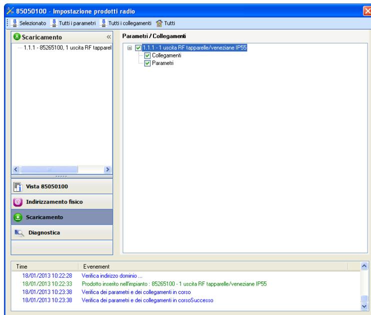
Attenzione : Durante i test funzionali il plug-in dell'accoppiatore RF-TP deve essere disattivato.
