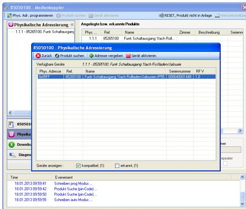
Die Schaltfläche **Gerät aktivieren** ermöglicht die Identifizierung und die Lokalisierung des ausgewählten Produkts.
