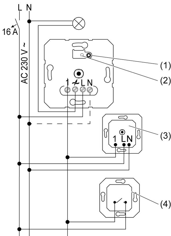
Figura 3: Schema di collegamento con regolatori esterni opzionali
