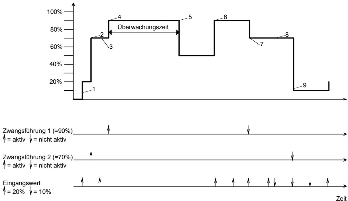
Die obige Abbildung zeigt das Zusammenspiel zwischen den Kommunikationsobjekten „Eingangswert“ und „Zwangsführung“ in Verbindung mit einer Überwachung. Die Pfeile zeigen jeweils den Zeitpunkt eines Telegramms.
