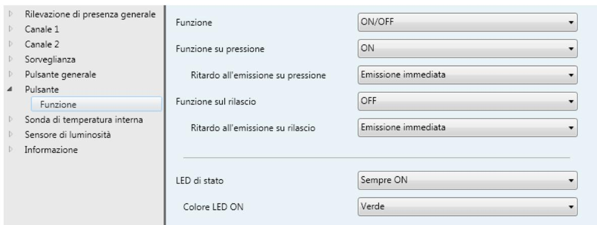
Figura 11: Tipo di funzione del tasto singolo/dei tasti singoli
