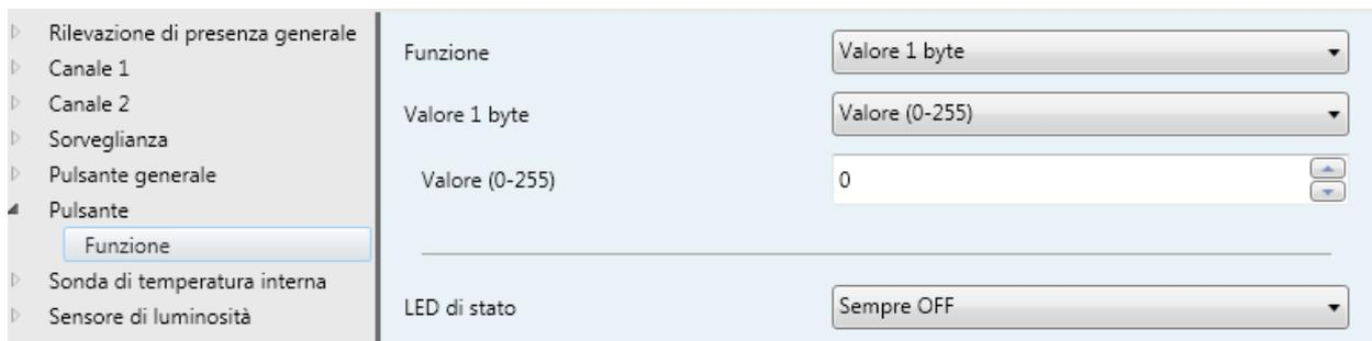
Figura 21: Funzione del tasto singolo "Valore 1 byte"
