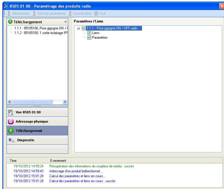
Attention : Le plug-in du coupleur de média doit être désactivé lors des tests fonctionnels.
