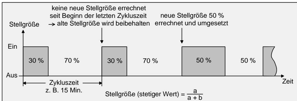
Bei einer Stellgröße von 0 % (dauernd ausgeschaltet) oder 100 % (dauernd eingeschaltet) wird nach Ablauf einer Zykluszeit stets ein Stellgrößentelegramm entsprechend des Stellgrößenwerts ("0" oder "1") ausgegeben. Auch das 'Clipping' (vgl. "stetige PI-Regelung") ist bei dieser Regelungsart aktiv.
