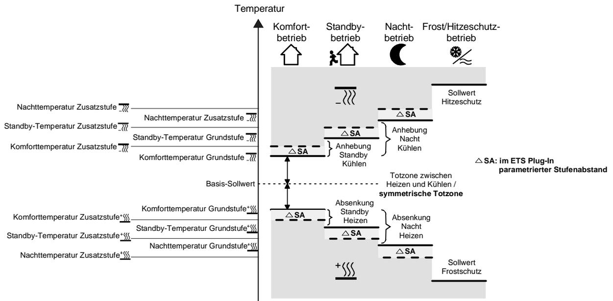
In der Betriebsart "Heizen und Kühlen" können 6 Temperatur-Sollwerte, falls in der ETS freigegeben, verändert werden. In Abhängigkeit der in der ETS parametrisierten Temperatur-Absenkung, -Anhebung oder Totzone leiten sich alle Temperatur-Sollwerte aus der Basis-Solltemperatur ab.
