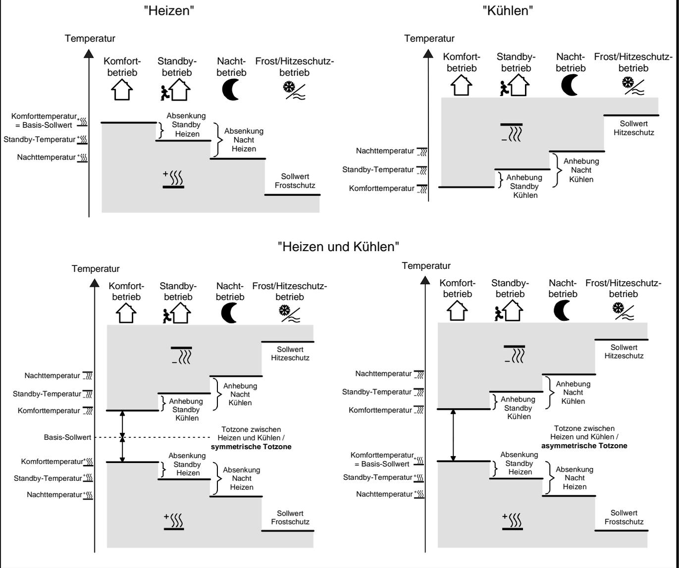
Temperaturregelung mit Zusatzstufe am Beispiel "Heizen und Kühlen" mit symmetrischer Totzone...
