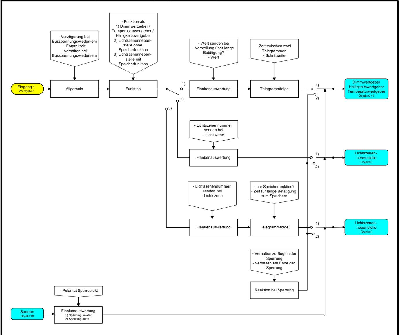
**Funktionsschaltbild (für Schaltausgänge / z. B. Ausgang 1)**
