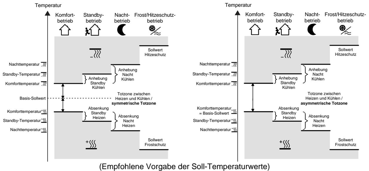
In dieser Betriebsart existieren die Solltemperaturen für Komfort-, Standby- und Nachtbetrieb beider Betriebsarten sowie die Totzone. Zusätzlich können die Frostschutz- und die Hitzeschutztemperaturen vorgegeben werden. Dabei gilt:
