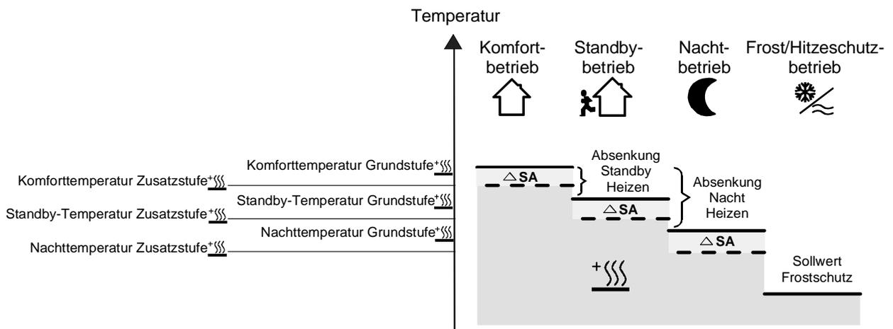
$$T_{\text{Komfort-Soll Zusatzstufe Heizen}} \leq T_{\text{Komfort-Soll Grundstufe Heizen}} \quad / \quad T_{\text{Standby-Soll Zusatzstufe Heizen}} \leq T_{\text{Standby-Soll Grundstufe Heizen}}$$
