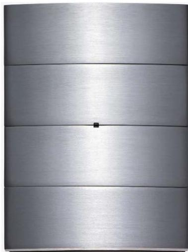
Der B.IQ Tastsensor Komfort wird auf einen Unterputz-Busankoppler (UP-BA) gesteckt. Seine Tasten können jeweils mit folgenden Funktionen belegt werden: Schalten, Dimmen, Jalousie, Wertgeber, Lichtszenenabruf, Zwangsführung und Steuerung. Die Tastenzuordnung ist frei wählbar und wird durch die Projektierung festgelegt.
