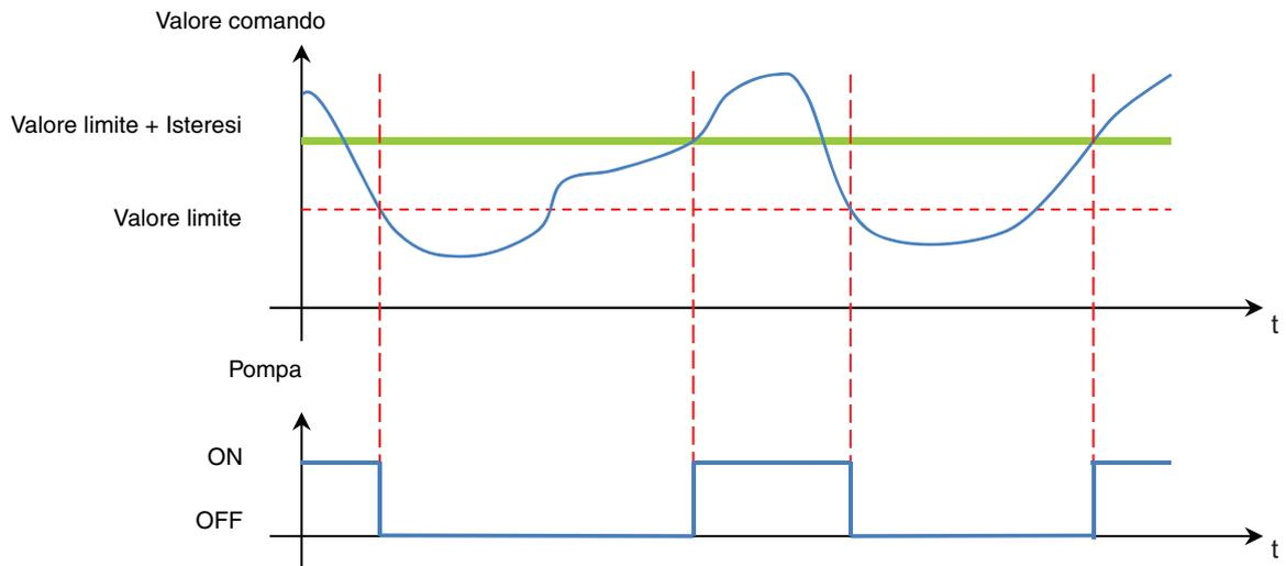
Questo oggetto permette di inviare un comando pompa del dispositivo al bus KNX per pilotare direttamente una pompa di circolazione di un impianto di riscaldamento o di raffreddamento. La pompa è attivata dal prodotto solo se uno dei valori impostati per le uscite interessate supera uno dei valori soglia definiti, sommati all'isteresi. La pompa è disattivata non appena il valore torna al di sotto del valore soglia.
