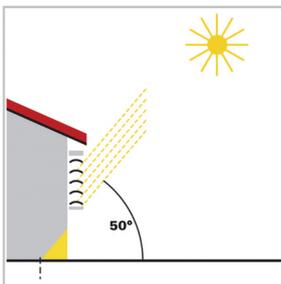
La protezione solare è chiusa solo parzialmente e si abbassa automaticamente fino a raggiungere un dato punto per non permettere al sole di entrare nel locale oltre la profondità di penetrazione massima preimpostata.
