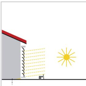
La protezione solare si abbassa automaticamente e quasi completamente per impedire ai raggi del sole di entrare troppo nel locale.
