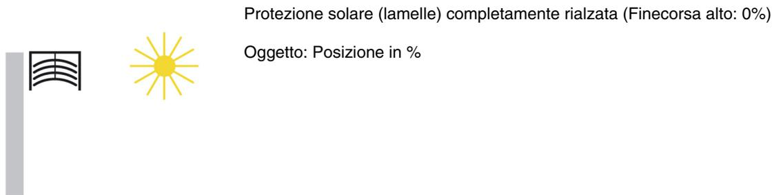
Se è richiesta la posizione più bassa, ciò viene specificato all'attuatore della persiana come posizione protezione solare 100% o raggiungimento finecorsa basso (Protezione solare completamente abbassata). La posizione viene segnalata mediante tale valore. Se la persiana viene abbassata a partire dal finecorsa alto le lamelle passano in posizione quasi verticale, quindi la protezione solare si abbassa fino a raggiungere il finecorsa basso con le lamelle chiuse.
