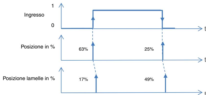
*N.B.: Il valore dell'oggetto **Posizione in %** è inviato prima del valore dell'oggetto **Posizione lamelle in %** per fare in modo che il modulo di uscita possa posizionare la veneziana prima di inclinare le lamelle.*
