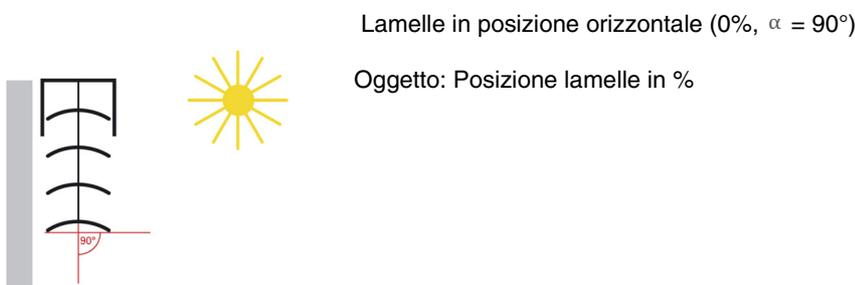
Nelle persiane standard la posizione delle lamelle, quando orizzontale, può essere modificata fino a quando le lamelle non sono completamente inclinate e la veneziana inizia a salire. In tale fase le lamelle formano un angolo compreso tra  $0^\circ$  e  $90^\circ$  con la verticale.
