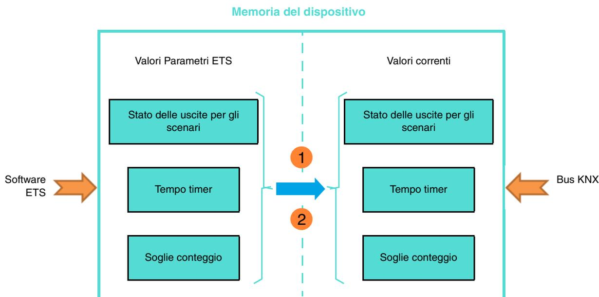
**1** Ricezione del valore 1 da parte dell'oggetto **Reset parametri ETS**: Sostituzione dei valori correnti con i valori ETS.
