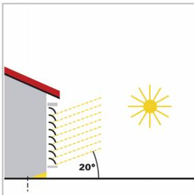
La protezione solare si abbassa automaticamente in modo da non far oltrepassare ai raggi del sole la profondità di penetrazione massima preimpostata.
