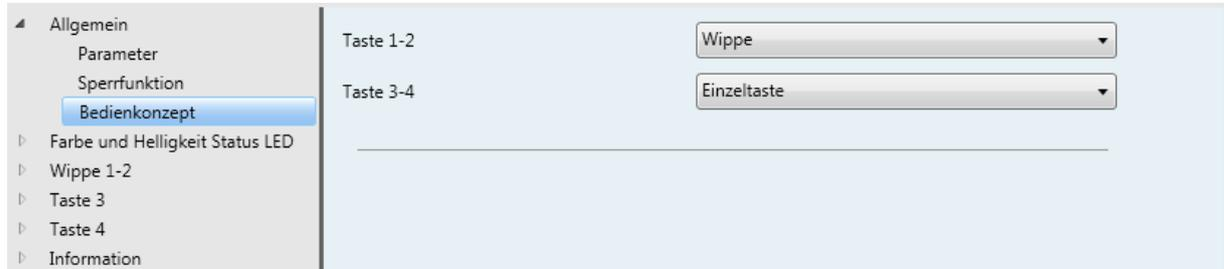
Bild 7: Parameter „Bedienkonzept“
