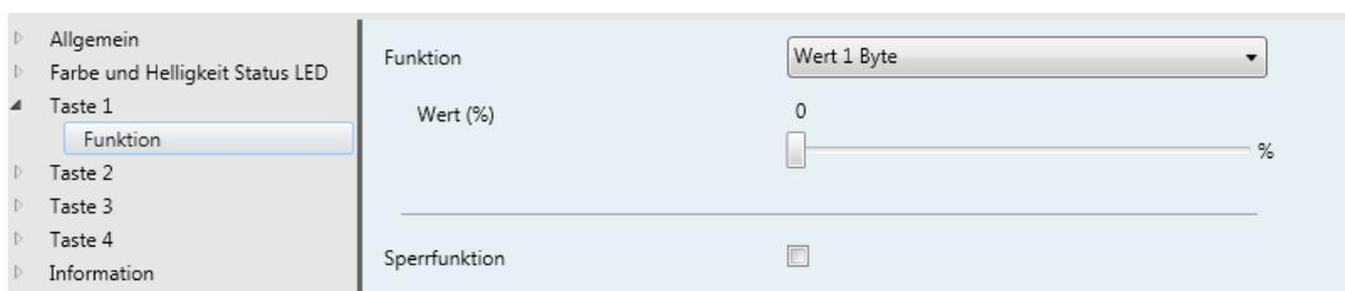
Bild 21: Funktion der Wippe „Wert 1-Byte“
