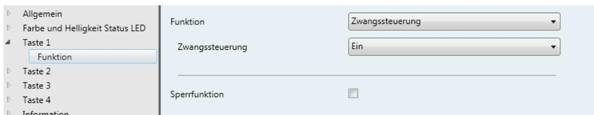
Bild 24: Funktion „Zwangssteuerung“
