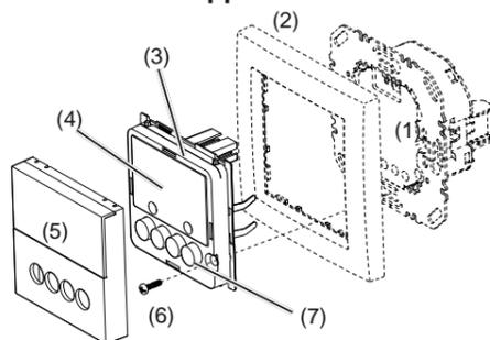
Figura 1: Struttura apparecchio
