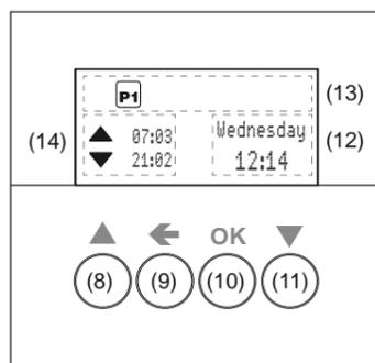
Figura 2: elementi di visualizzazione e comando
