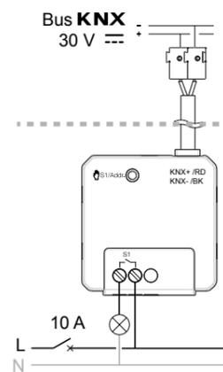
Figura 3: collegamento dell'apparecchio singolo
