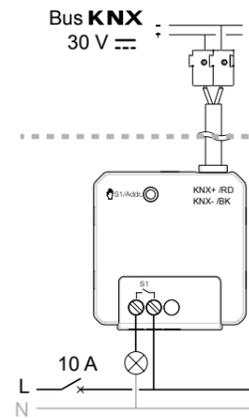
Bild 3: Geräteanschluss 1fach
