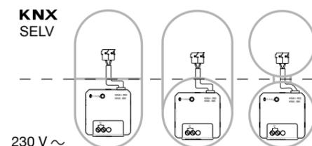
Figura 2: installazione con punto di collegamento separato
