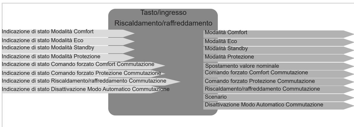
Figura 7: Segnali di ingresso/uscita funzione Riscaldamento/raffreddamento
