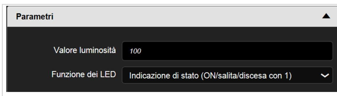
Figura 36: Determinazione valore regolazione luce
