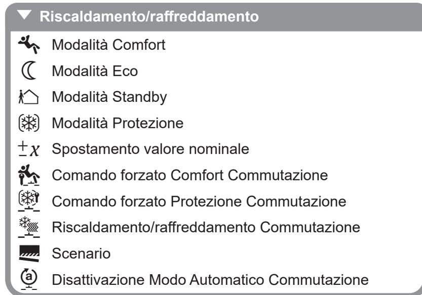
Figura 60: Panoramica delle funzioni **Riscaldamento/raffreddamento**
