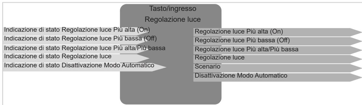
Figura 5: Segnali di ingresso/uscita funzione Regolazione luce
