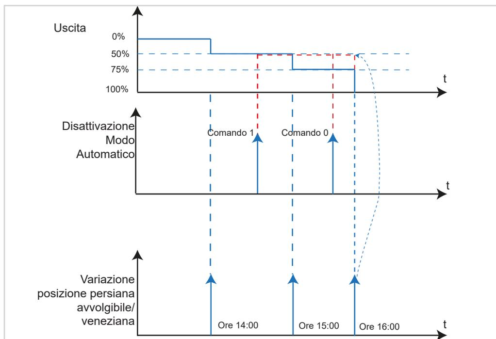
Figura 58: Diagramma segnale-tempo Disattivazione Modo Automatico
