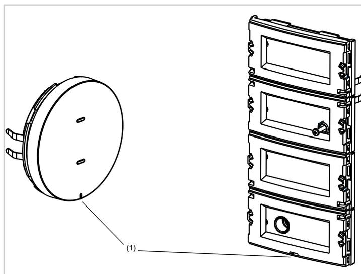
Figura 14: Retroilluminazione LED sensore a tasti R.x (sinistra) - S.1 (destra)
