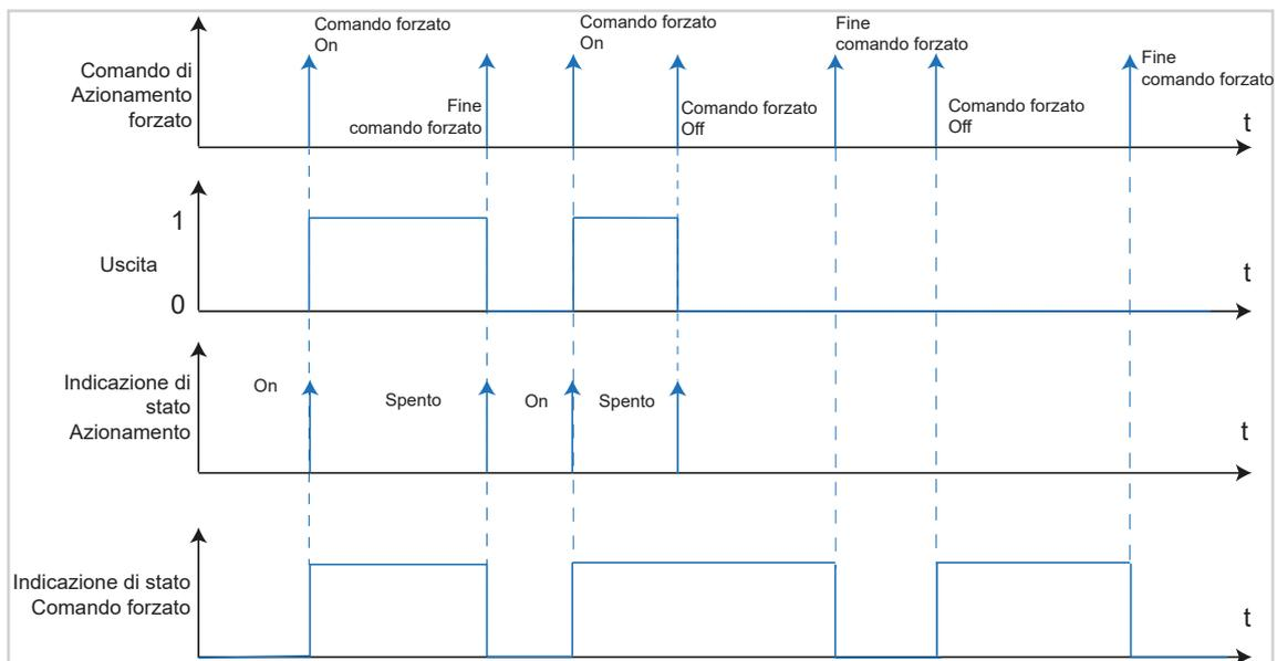
Figura 27: Diagramma segnale-tempo comando forzato
