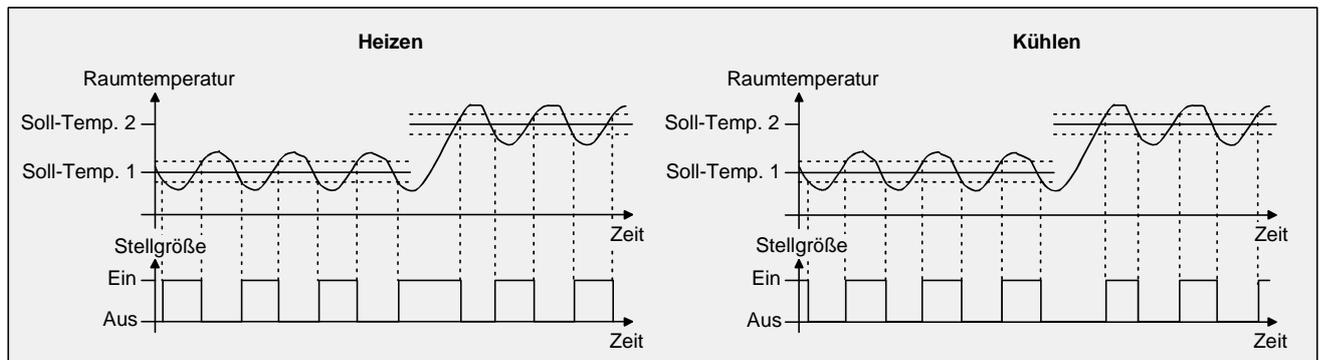
Eine Zusatzheiz- oder Zusatzkühlstufe als 2-Punkt-Regelung funktioniert genau wie die 2-Punkt-Regelung der Grundstufe mit dem Unterschied, dass sich der Sollwert und die Hysterese-werte unter Berücksichtigung des parametrierten Stufenabstands verschieben.
