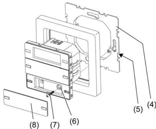
1. Montieren Sie den Tragrings (4) lagerichtig auf eine UP-Gerätedose (DIN 49073). Die Demontagesicherung (5) muss sich unten rechts befinden.
