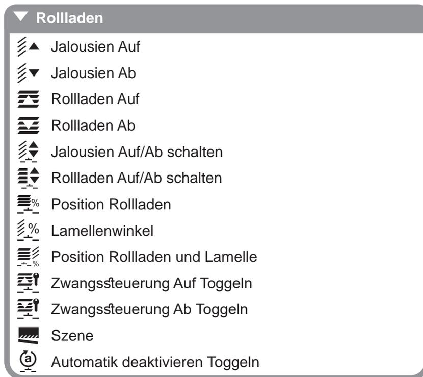
Bild 45: Funktionsübersicht **Rollladen**
