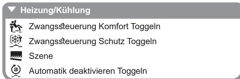
Bild 70: Funktionsübersicht **Heizung/Kühlung**
