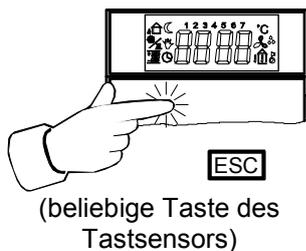
Soll der Programmiermodus oder das angewählte Menü (Rücksprung in das übergeordnete Menü) verlassen werden, ist eine beliebige Taste des Tastsensors (nicht die Anzeigetasten) zu drücken. Wenn die Übernahme eines verstellten Werts nicht gewünscht wird, ist ebenfalls der Escape-Befehl auszuführen. In diesem Fall wird der verstellte Wert nicht in den Speicher des Geräts übernommen.
