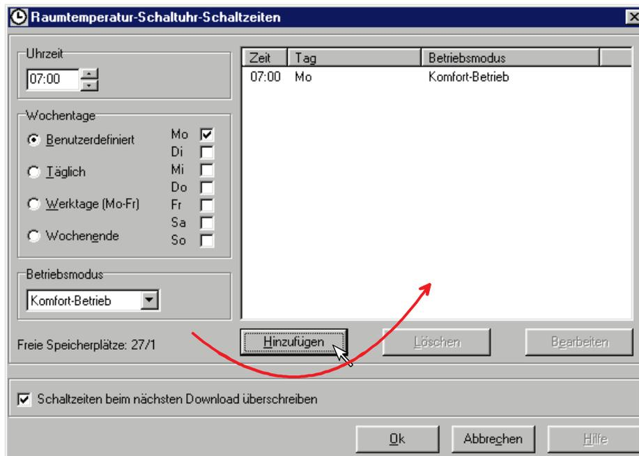
Auf diese Weise können die bis zu 28 Schaltprogramme vorprogrammiert werden. Ein im rechten Teil des Fensters angelegtes Programm kann bearbeitet werden, wenn es markiert und die Schaltfläche "Bearbeiten" gedrückt wird. Durch Markieren und Betätigung der Schaltfläche "Löschen" wird das Programm gelöscht und aus der Liste entfernt.
