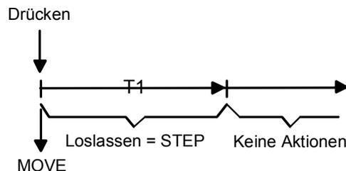
Mit dem Drücken der Taste wird ein Move gesendet und die Zeit T1 ("Lamellenverstellzeit") gestartet. Wenn dann innerhalb von T1 wieder losgelassen wird, sendet der Tastensensor ein Step-Telegramm aus. Diese Funktion wird zur Lamellenverstellung benutzt. T1 sollte der Zeit einer 180° Lamellendrehung entsprechen.
