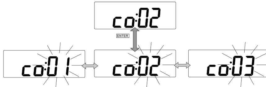
Der Kontrastwert kann durch Betätigung der linken oder rechten Anzeigetaste in negative und positive Richtung verstellt werden (min. "co:00" / max. "co:10").
