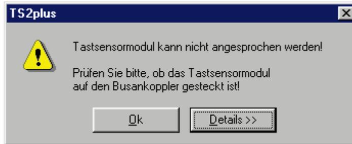
Tritt auf: Beim Versuch, die Applikationsdaten in das Gerät zu laden.
