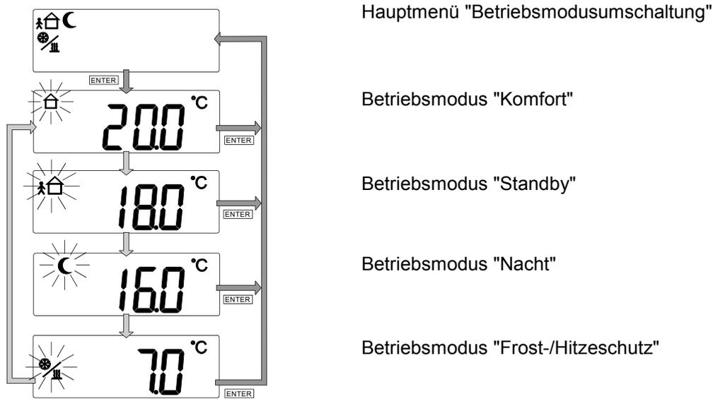
Der durch die Anzeigetasten angewählte Betriebsmodus wird durch den Befehl "Enter" übernommen. Danach springt die Anzeige in das Hauptmenü des Programmiermodus zurück.
