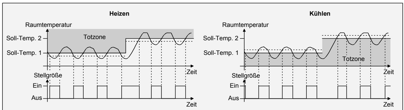
Eine Zusatzheiz- oder Zusatzkühlstufe als 2-Punkt-Regelung funktioniert genau wie die 2-Punkt-Regelung der Grundstufe mit dem Unterschied, dass sich der Sollwert und die Hysterese werte unter Berücksichtigung des parametrieren Stufenabstands verschieben.
