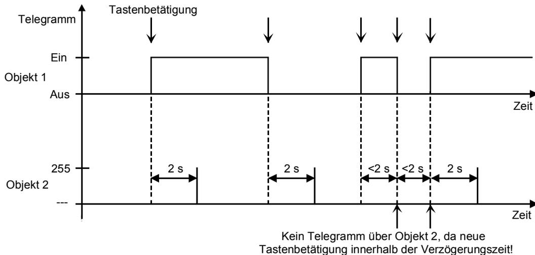
Die beiden Status-LED der Wippe (links und rechts) können unabhängig von der Wippenfunktion parametrierbar und angesteuert werden. Die Parameter "Funktion der linken / rechten Status-LED" im Parameterzweig "Tastensensor-Funktion / Bedienung / [Tastenbezeichnung] / Status Wippe X" legt fest, ob die LED dauerhaft ein- oder ausgeschaltet ist oder über das Objekt "Wippe X [Status links / rechts]" angesteuert wird. Im zuletzt genannten Fall ist die Polarität der Status-Objekte definierbar.
