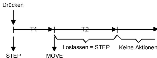
Mit dem Drücken einer Taste der Wippe wird ein Step gesendet und die Zeit T1 ("Zeit zwischen Kurz- und Langzeitbetrieb") gestartet. Wenn innerhalb von T1 wieder losgelassen wird, wird kein weiteres Telegramm gesendet. Dieser Step dient zum Stoppen einer laufenden Dauerfahrt.
