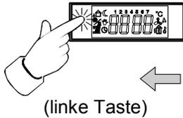
Wechsel eines Menüpunktes durch Navigation nach links oder Wertverstellung (z. B. Temperaturwert oder Schaltzeit) in negative Richtung.
