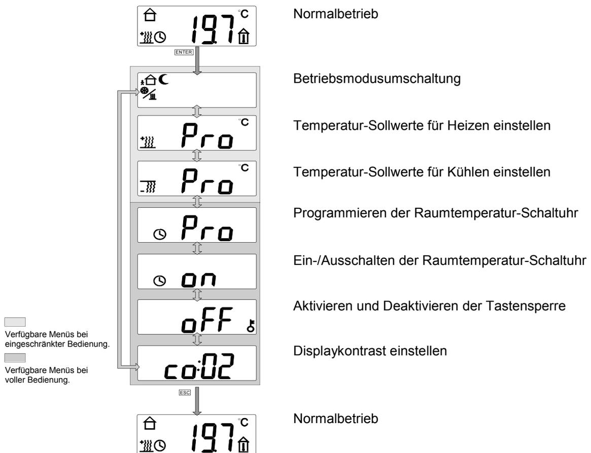
Der Programmiermodus wird durch ca. 3 s lange Betätigung beider Anzeigetasten aufgerufen. Danach ist das Hauptmenü aktiviert. Mit den Anzeigetasten kann an dieser Stelle zwischen den einzelnen Menüpunkten navigiert werden. Die entsprechenden Untermenüs werden bei angewähltem Menü durch Betätigung beider Anzeigetasten ("Enter") aufgerufen.
