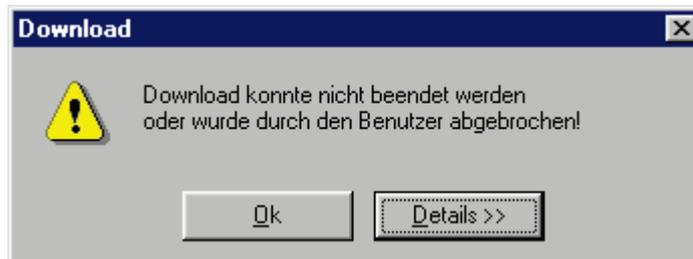
Tritt auf: Beim Versuch, die Applikationsdaten in das Gerät zu laden.
