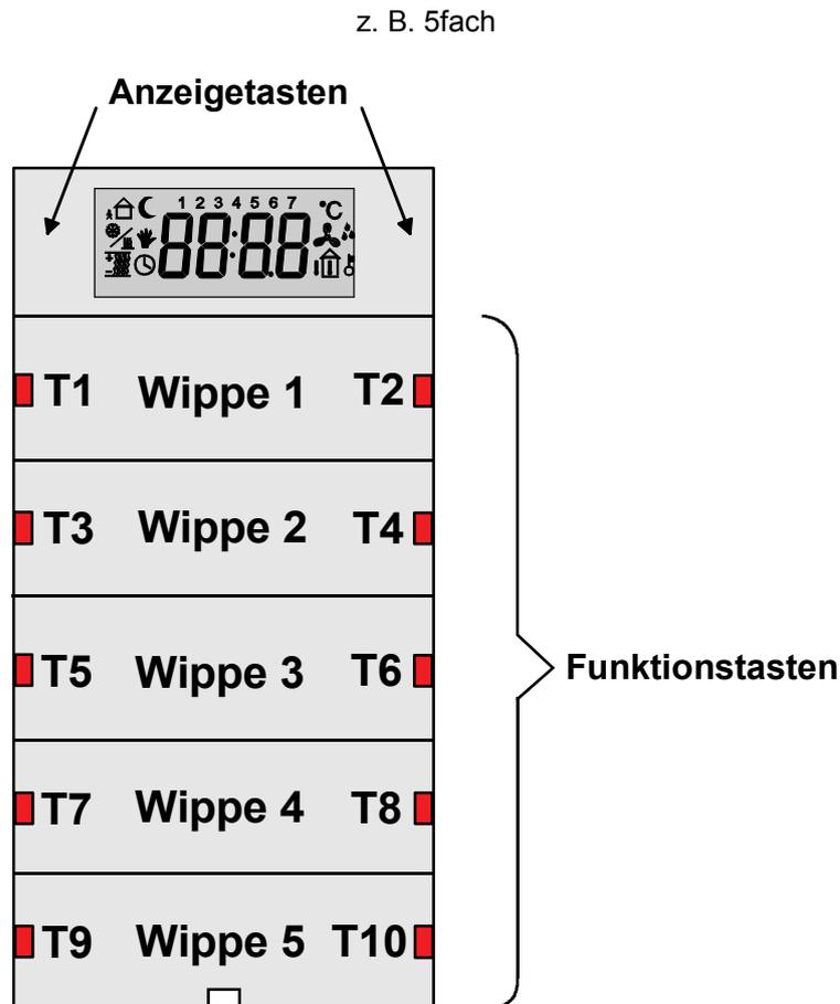
In Abhängigkeit der im ETS-Projekt eingefügten Applikation (2 fach, 3fach oder 5 fach) wird im ETS Plug-In die benötigte Anzahl der Wippen und LED automatisch angelegt.
