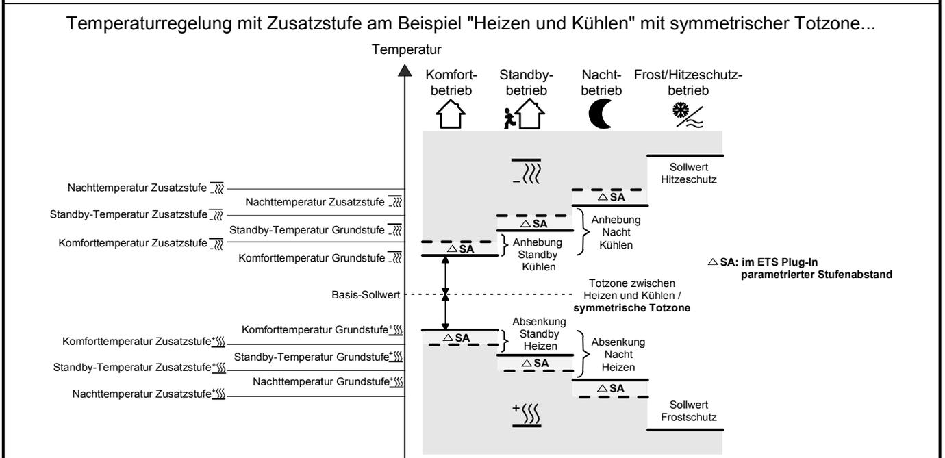
In der Betriebsart "Heizen und Kühlen" können 6 Temperatur-Sollwerte, falls im ETS Plug-In freigegeben, verändert werden. In Abhängigkeit der in der ETS parametrisierten Temperatur-Absenkung, -Anhebung oder Totzone leiten sich alle Temperatur-Sollwerte aus der Basis-Solltemperatur ab.
