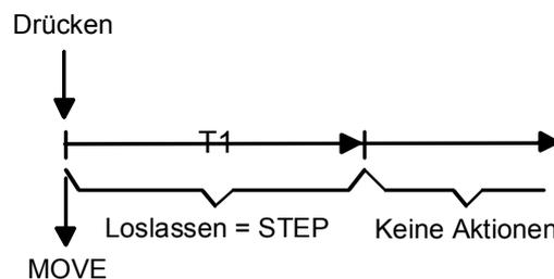
Mit dem Drücken einer Taste der Wippe wird ein Move gesendet und die Zeit T1 ("Lamellenverstellzeit") gestartet. Wenn dann innerhalb von T1 wieder losgelassen wird, sendet der Tastsensor ein Step-Telegramm aus. Diese Funktion wird zur Lamellenverstellung benutzt. T1 sollte der Zeit einer 180° Lamellendrehung entsprechen.
