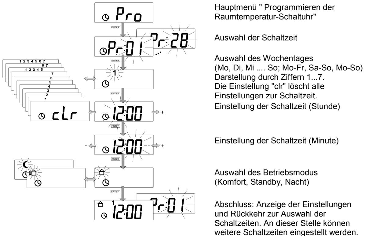
Zunächst muss die Schaltzeit, welche editiert werden soll, mit den Anzeigetasten ausgewählt werden. Schaltzeiten werden mit ihrer Nummer und der programmierten Zeit im Wechsel blinkend angezeigt. Bei freien Programmplätzen erscheint statt der Zeit eine leere Anzeige " - - : - - ". Durch "Enter" kann die ausgewählte Schaltzeit bearbeitet werden.
