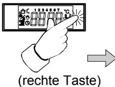
Wechsel eines Menüpunktes durch Navigation nach rechts oder Wertverstellung (z. B. Temperaturwert oder Schaltzeit) in positive Richtung.
