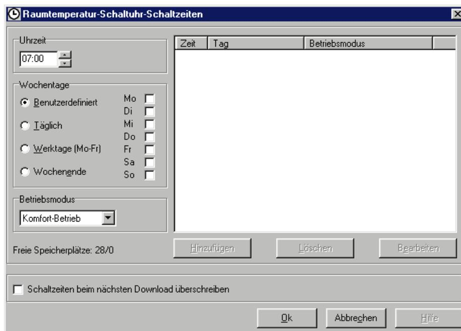
Im linken Teil des Fensters wird minutengenau die Uhrzeit des Schaltprogramms angegeben. Weiter werden die Wochentage definiert, an denen die Schaltzeit ausgeführt werden soll. Es steht die Auswahl "Benutzerdefiniert" (Mo, Di, ..., So), "Täglich" (Mo – So), "Werktage" (Mo – Fr) oder "Wochenende" (Sa – So) zur Verfügung.
