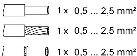
Figura 4: Sezione trasversale conduttore
