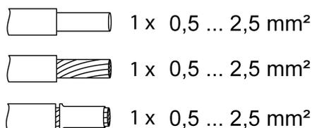
Figura 4: Sezione trasversale conduttore
