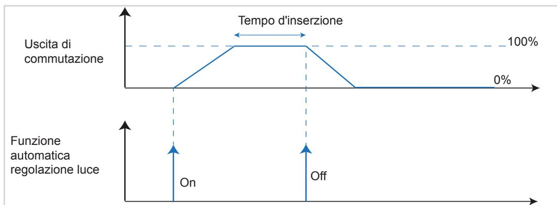
Figura 28: Diagramma segnale-tempo **Funzione automatica regolazione luce**
