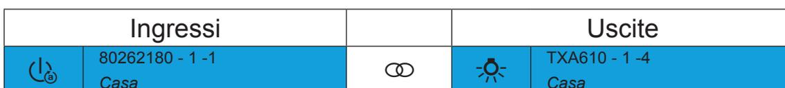
Figura 68: Collegamento **master - uscita attuatore**
