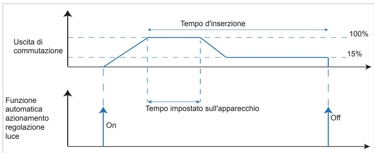
Figura 31: Diagramma segnale-tempo **Funzione automatica azionamento regolazione luce**
