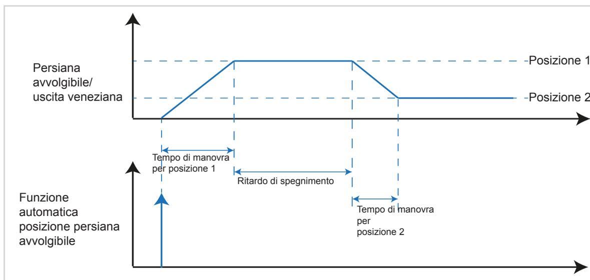
Figura 53: Diagramma segnale-tempo **Funzione automatica posizione persiana avvolgibile**
