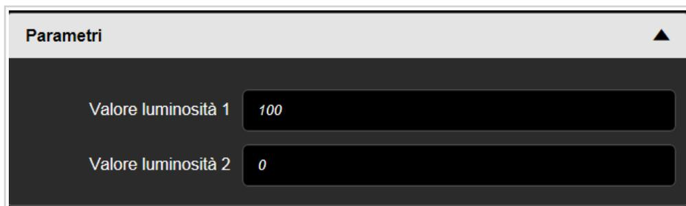
Figura 29: Impostazione valore di regolazione luce 1/2 - **Funzione automatica regolazione luce**
