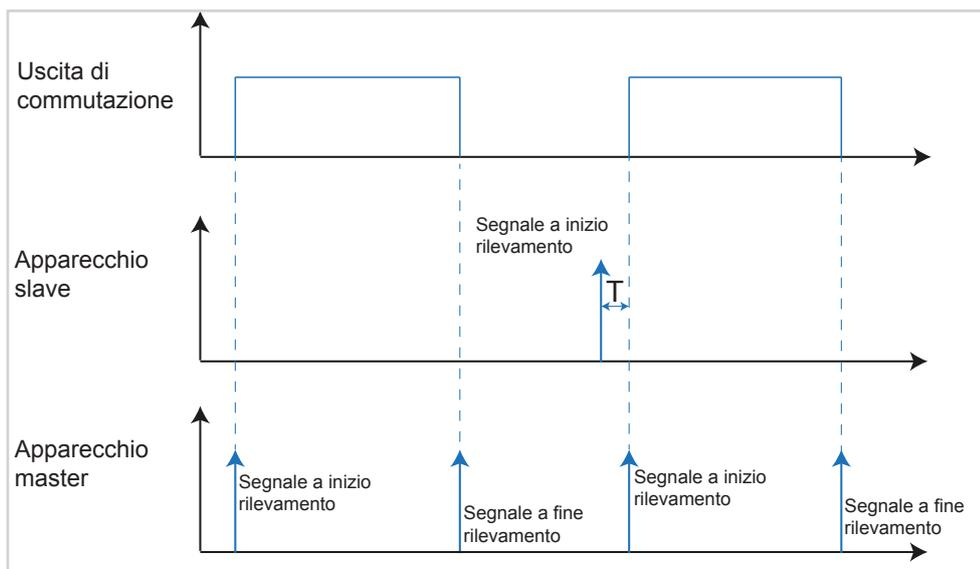
Figura 70: Diagramma segnale-tempo applicazione master - slave
