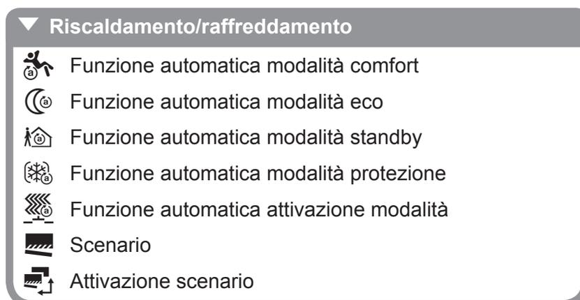
Figura 59: Panoramica delle funzioni **Riscaldamento/raffreddamento**
