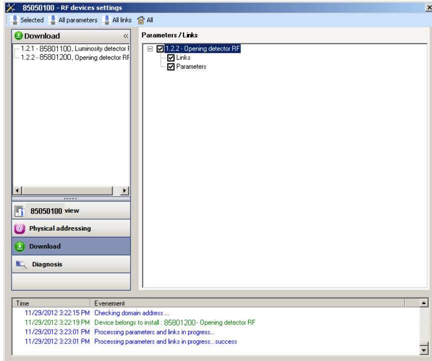
Om de functie en de KNX RF communicatie te testen, moet u naar de normale exploitatiemodus terugkeren en 15 s wachten alvorens op de bedieningstoets van een zender te drukken.
