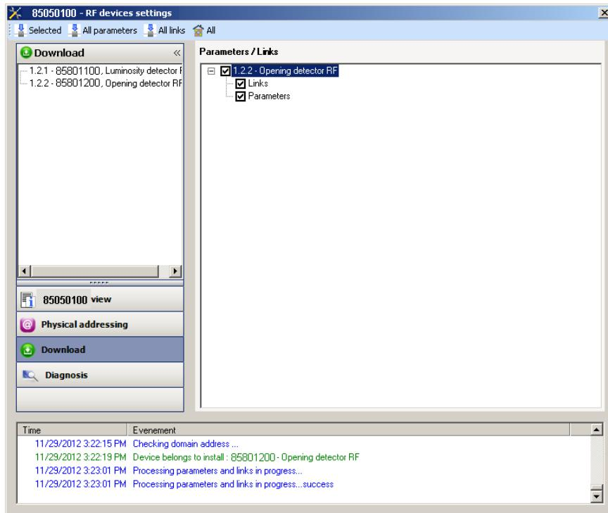
Para comprobar las funciones y la comunicación vía radio KNX, vuelva al modo de explotación normal y espere 15 s antes de pulsar una tecla de control de un emisor.
