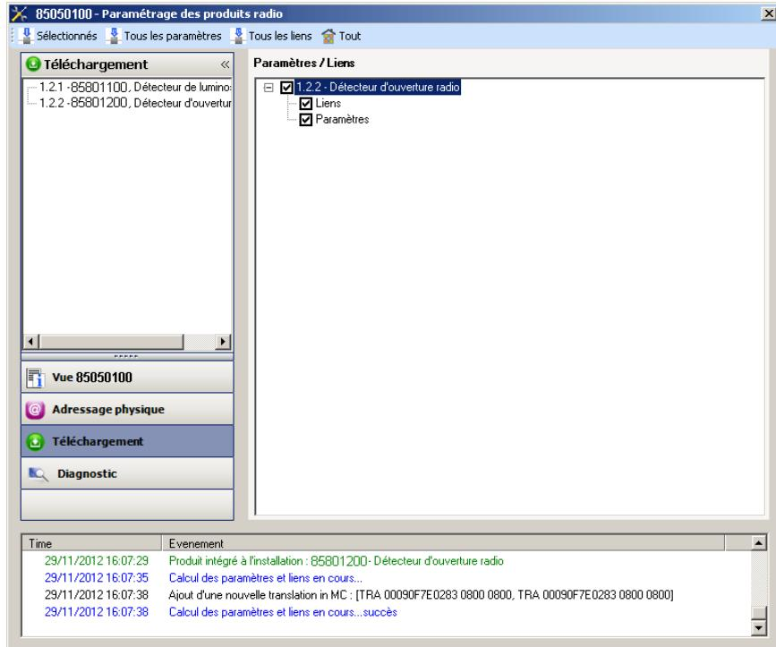
Pour tester les fonctions et la communication radio KNX, retourner en mode d'exploitation normal et attendre 15 s avant d'appuyer sur une touche de commande d'un émetteur.
