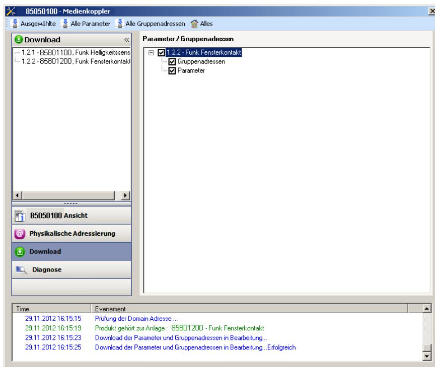
Gehen Sie für den Test der KNX Funkfunktionen und -kommunikation zurück in den normalen Betriebsmodus und warten Sie 15 s vor Betätigung der Befehlstaste eines Senders.
