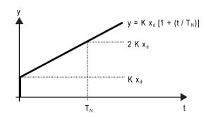
Bild 33: Funktion der Stellgröße einer PI-Regelung
