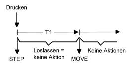
Bild 20: Bedienkonzept "Kurz - Lang"
