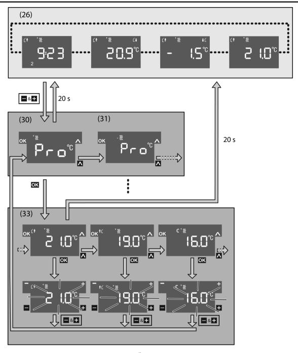
Bild 12: Untermenü zur Änderung der Solltemperaturen
