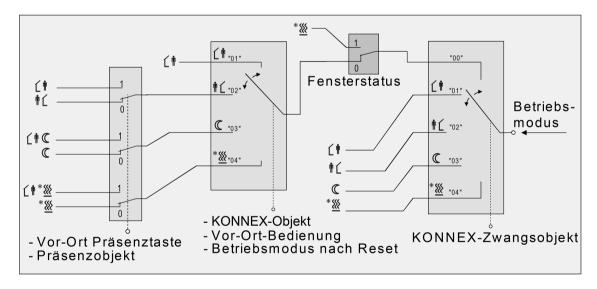
Bild 37: Betriebsmodusumschaltung durch KONNEX Objekt mit Präsenztaste
