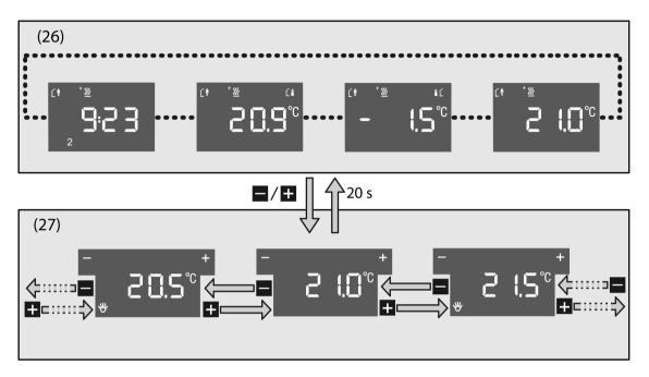
Bild 8: Basis-Sollwertverschiebung durch Displaytasten
