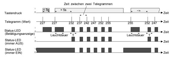
Bild 22: Beispiel zur Wertverstellung ohne Wertbereichs-Überlauf
