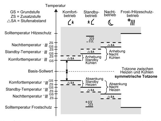
Bild 45: Solltemperaturen in der Betriebsart "Grund- und Zusatzheizen und -kühlen" mit symmetrischer Totzone (empfohlene Vorgabe)
