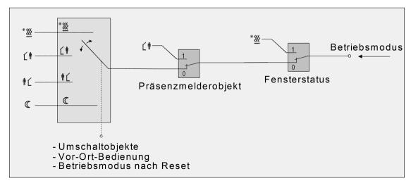
Bild 36: Betriebsmodusumschaltung durch 4 x 1 Bit Objekte mit Präsenzmelder
