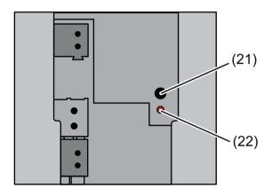
Bild 6: Programmiertaste und -LED auf der Geräterückseite
