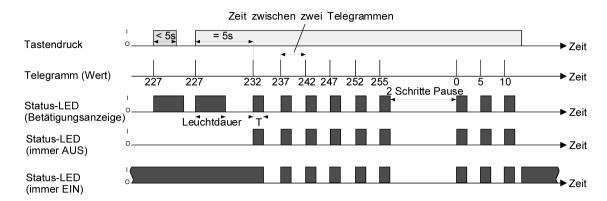
Bild 23: Beispiel zur Wertverstellung mit Wertbereichs-Überlauf
