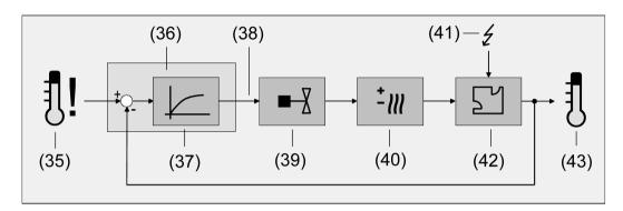
Bild 26: Regelstrecke einer Einzelraum-Temperaturregelung
