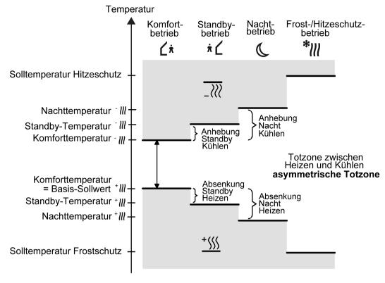
Bild 44: Solltemperaturen in der Betriebsart "Heizen und Kühlen" mit asymmetrischer Totzone (empfohlene Vorgabe)
