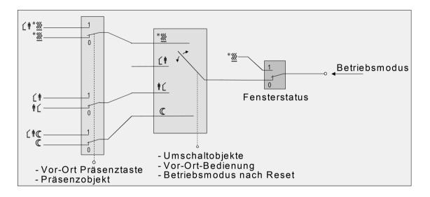
Bild 35: Betriebsmodusumschaltung durch 4 x 1 Bit Objekte mit Präsenztaste
