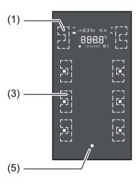
Bild 13: Tastenanordnung (am Beispiel der Gerätevariante 3fach)
