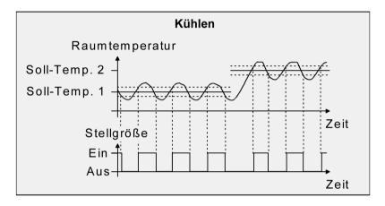
Bild 30: 2-Punkt-Regelung für Einzelbetriebsart "Kühlen"
