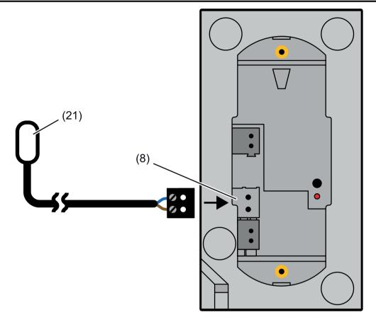
Bild 47: Anschluss für bedrahteten Temperatur-/Fernfühler
