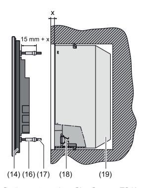
Bild 4: Gerätemontage eines Glas-Sensors TS Komfort
