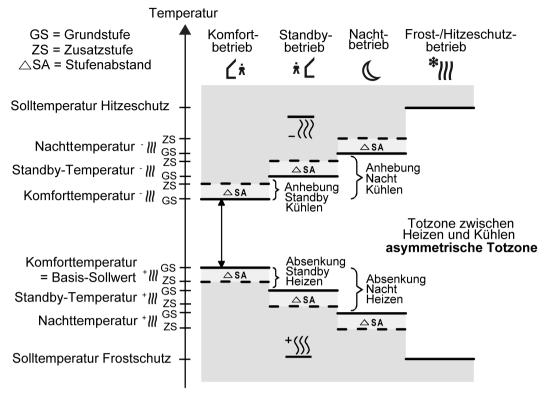
Bild 46: Solltemperaturen in der Betriebsart "Grund- und Zusatzheizen und -kühlen" mit asymmetrischer Totzone (empfohlene Vorgabe)
