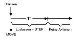
Bild 19: Bedienkonzept "Lang - Kurz"
