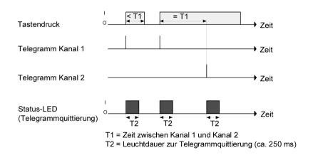
Bild 25: Beispiel zum Bedienkonzept "Kanal 1 und Kanal 2"
