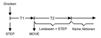
Bild 18: Bedienkonzept "Kurz-Lang-Kurz"
