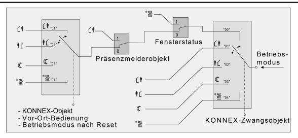
Bild 38: Betriebsmodusumschaltung durch KONNEX Objekt mit Präsenzmelder
