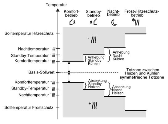
Bild 43: Solltemperaturen in der Betriebsart "Heizen und Kühlen" mit symmetrischer Totzone (empfohlene Vorgabe)
