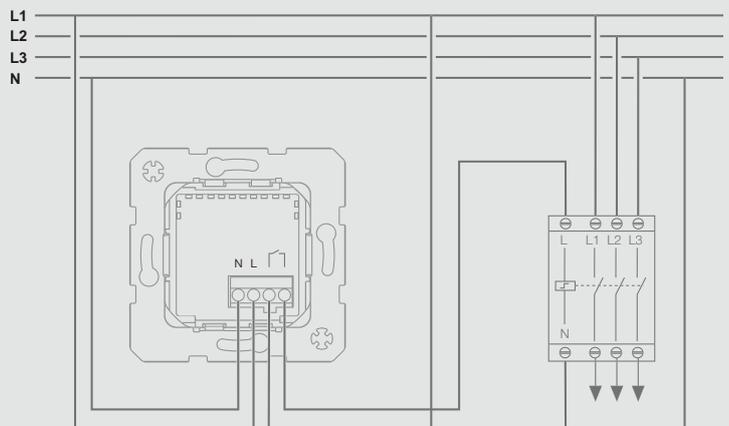
Bei erhöhtem Leistungsbedarf, z. B. in größeren Suiten mit Sauna oder Whirlpool, können weitere Stromkreise über ein Installationsrelais oder -schutz in der Unterverteilung angeschlossen werden.
